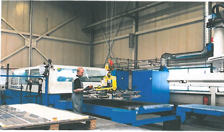
De platen worden met zuignappen verplaatst.
